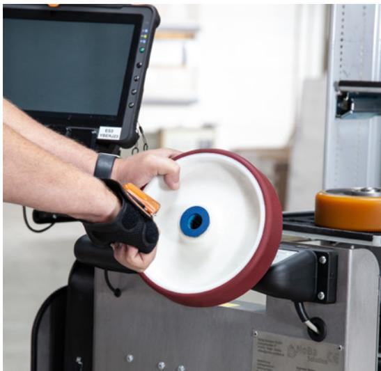
NoBa Solution drosselte das Tempo des E-Drive-Systems von TENTE auf vier Kilometer pro Stunde, damit der Wagen, selbst falls ein Mitarbeiter auf den vorderen auffährt, ohne jegliche Bremse stoppt und keine Verletzungen hervorruft. Ein Fußschutz vor den Rollen sorgt dafür, dass es auch hier zu keinen Unfällen kommt.
