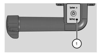
Der im Akkumodul enthaltene Akku verschleißt mit zunehmender Nutzungsdauer. Dadurch verringert sich zunehmend die Ladekapazität. Wenn die Ladekapazität für einen effizienten Betrieb nicht mehr ausreicht, müssen Sie das Akkumodul gegen ein neues vom gleichen Typ austauschen.
