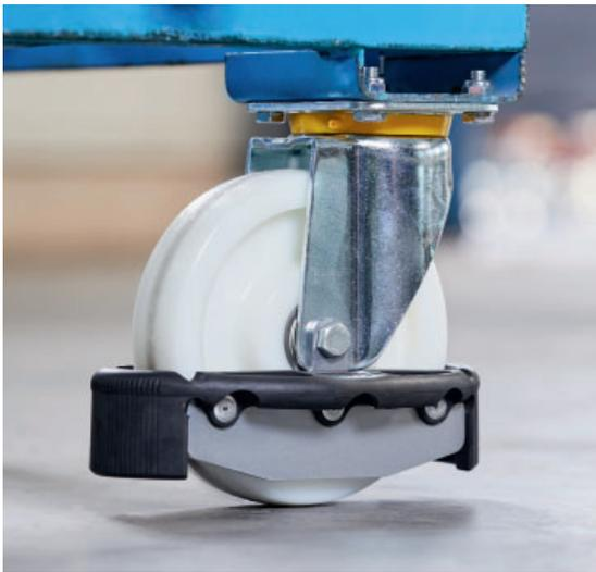
maximale pour les employés, des jupes flexibles faites de caoutchouc avec une dureté shore de 80 ont été installées devant et derrière la roue du chariot de transport. Les jupes sont taillées de telle façon qu'elles s'enfoncent sous la roue dès que la roue entre en contact avec le pied. Cela évite à la roulette de passer par dessus le pied et de l'écraser.
