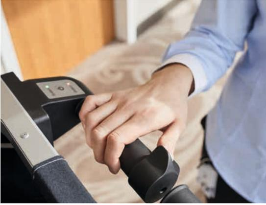
15台のサービストロリーのそれぞれにE-Driveを装備しました。台車の持ち手に取り付けたコントロールハンドルにより、簡単に操作できます。従業員がE-Driveを作動させると、電気駆動輪が下降し、トロリーの走行をサポートします。E-Drive以外のキャスターも使用条件に合わせて特別に選択されたものを採用し、トロリーの走行を著しく向上させることに成功しました。
