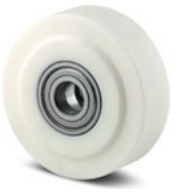
Roue MOP : Corps de roue et bandage en polyamide extra dur coulé et usiné avec un roulement à billes de précision.
