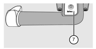
Der im Akkumodul enthaltene Akku verschleißt mit zunehmender Nutzungsdauer. Dadurch verringert sich zunehmend die Ladekapazität. Wenn die Ladekapazität für einen effizienten Betrieb nicht mehr ausreicht, müssen Sie das Akkumodul gegen ein neues vom gleichen Typ austauschen.
