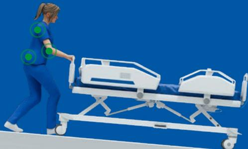
Das System sorgt für den nötigen Schub, fängt das schwere Gewicht des Bettes ab oder nimmt bei Bedarf Geschwindigkeit heraus.
